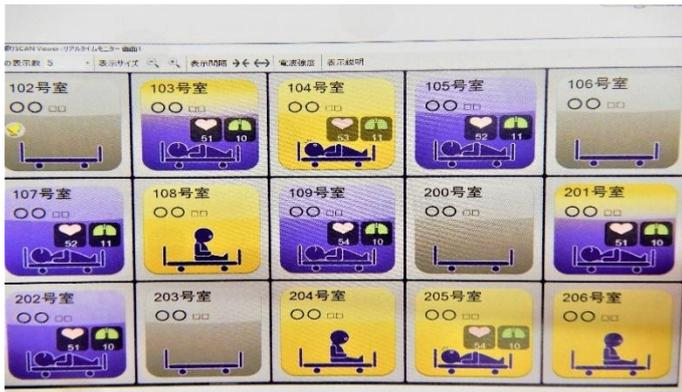
バイオシルバー社製『aams』を導入予定。専用センサーマットや見守りカメラを使用し、呼吸・心拍・体動・離床・睡眠状態をモニターで把握。また、他機器との連動により、介護ソフトでの読み取りやタブレット端末でのモニターの確認が可能。
